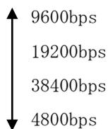
**※変更したボーレートは機器の電源を再投入した際に有効になります。**
