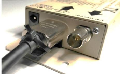
付属の CL-1 金具を予め本体へ取り付けます。取り付けネジは本体に出荷時に実装済みです。(M3 ビス)
