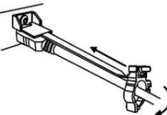
○固定具のサイドにあるロック機構をケーブルの太さに合わせて締め、HDMIケーブルが機器より抜けないようにコネクタを固定します。
