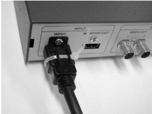
くびれのあるHDMIプラグとの束線縛り例
