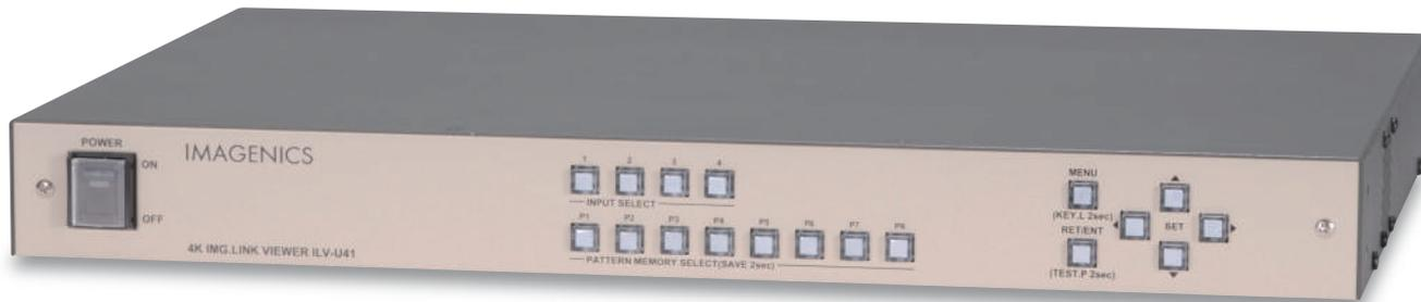
スキャンコンバータ(画面合成器)シリーズは、映像信号をマルチビュー合成して4K HDMI 信号へ変換出力することが可能な信号変換器です。HEV-U91/HEV-U41では4K HDMI信号入出力、ILV-U41では4K IMG.LINK信号入出力、SEV-U41では3G-SDI信号入出力に対応します。マルチビュー合成のレイアウトは、SEV-U41では田の字合成に対応。HEV-U91/HEV-U41/ILV-U41では任意のレイアウトに調整してフロントキーに8種類まで割り当てることができます。HEV-U91/ILV-U41では外部リファレンスを使用して、複数台使用によるマルチビジョン構成が可能です。
