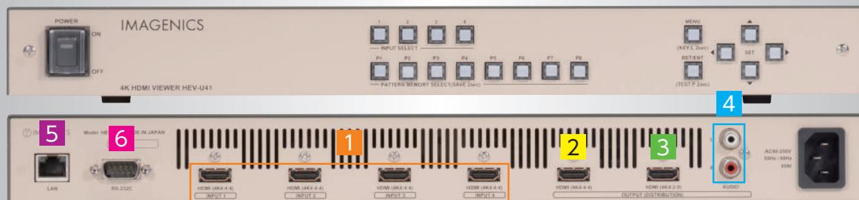
1 HDMI入力4K4:4:4 2 HDMI出力4K4:4:4 3 HDMI出力4K4:2:0 4 アナログ音声出力 5 LAN端子 6 RS-232C端子
