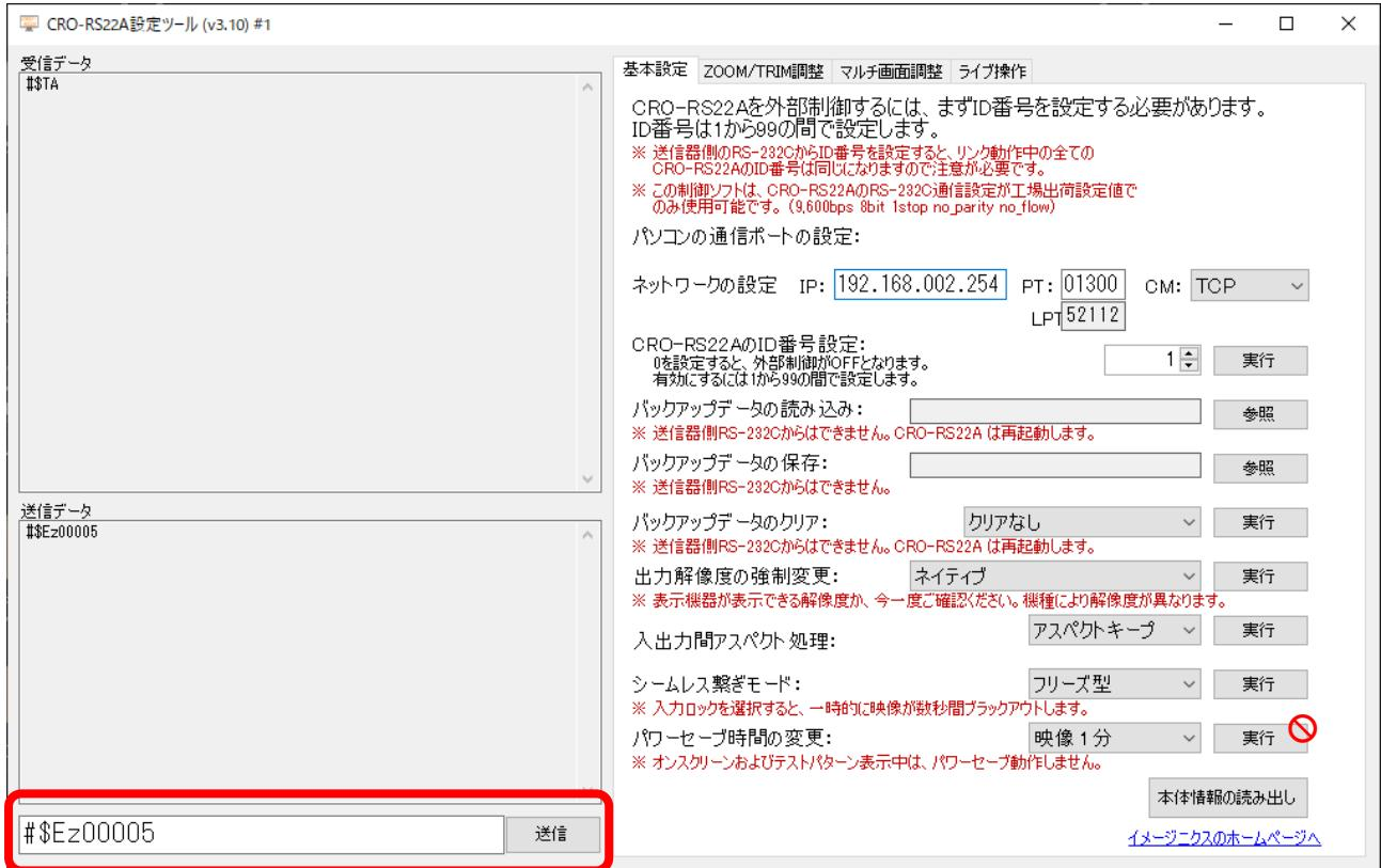
画面左下のテキストボックスに直接外部制御コマンド文字列を入力して、外部制御を実行することが可能です。CRO-R22A 設定アプリにて実装されていない US-84HRS 専用のコマンドはこちらから実行ください。テキストボックスの横の[送信]ボタンを押すことでコマンド文字列の末尾に[CR]コードを付与して US-84HRS にコマンド文字列を送信します。
