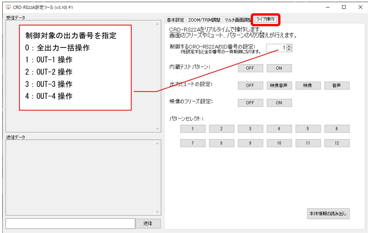
ライブ操作のタブでは、内蔵テストパターンの表示や、出力のミュート設定、映像のフリーズ設定など、バックアップメモリに保存されない、一時的な操作と、パターン動作モードの各パターンの呼び出しが実行できます。
