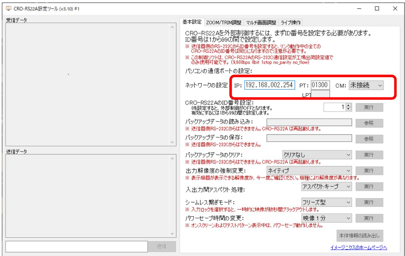
CRO-RS22A 設定アプリを起動したら、ネットワーク設定の「IP」と「PT」の項目に制御対象となる US-84HRS の IP アドレスとポート番号を入力して「CM」のプルダウンメニューから接続種別(TCP または UDP)を選択します。（工場出荷設定は IP:192.168.2.254／PT:1300／CM:TCP です。）
