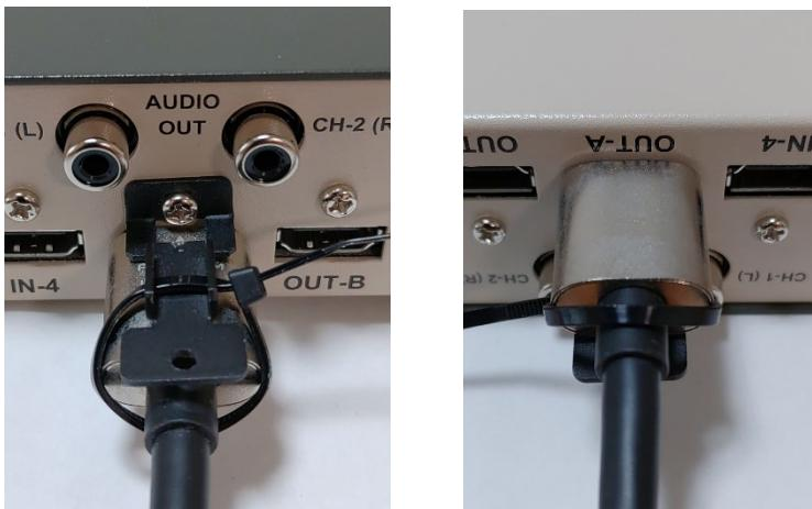
付属の CL-1 金具を予め本体へ取り付けます。取り付けネジは出荷時に、本体に実装済みです。 (M3 ビス)
