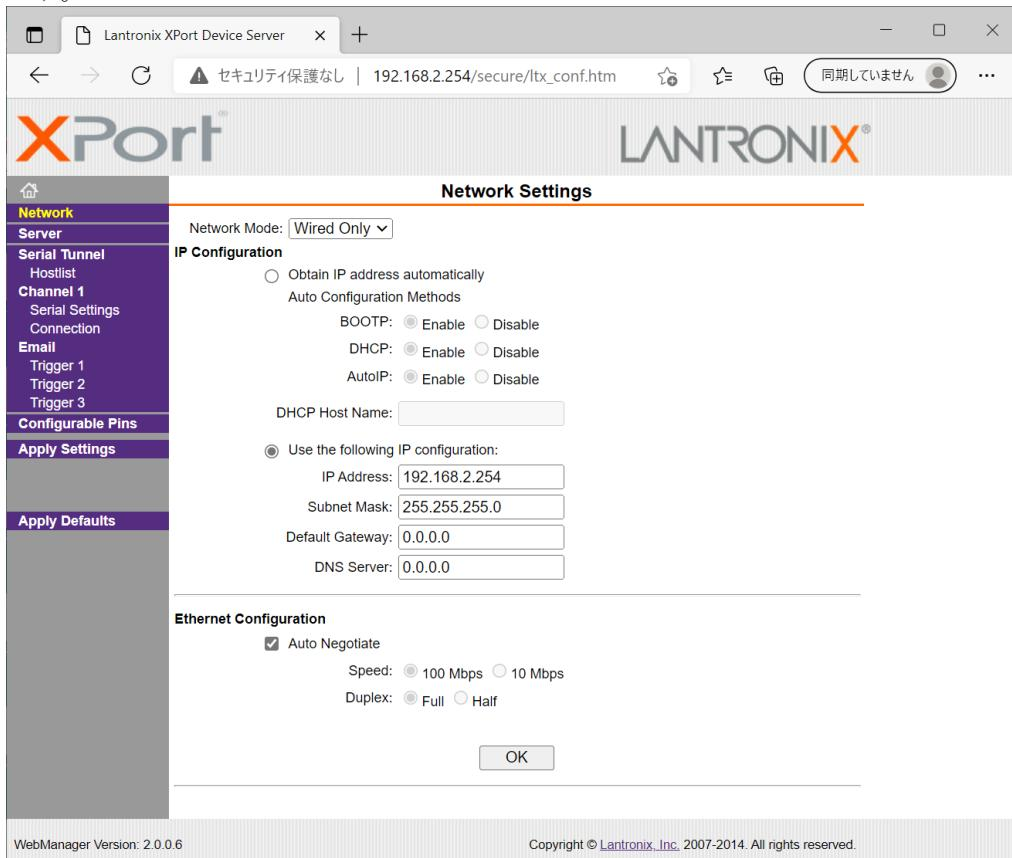
IP Address, Subnet Mask, Default Gateway, DNS Server の各設定を、お客様の使用環境に合わせて変更できます。その他の設定項目は基本的に変更しないでください。トラブルの原因になります。
