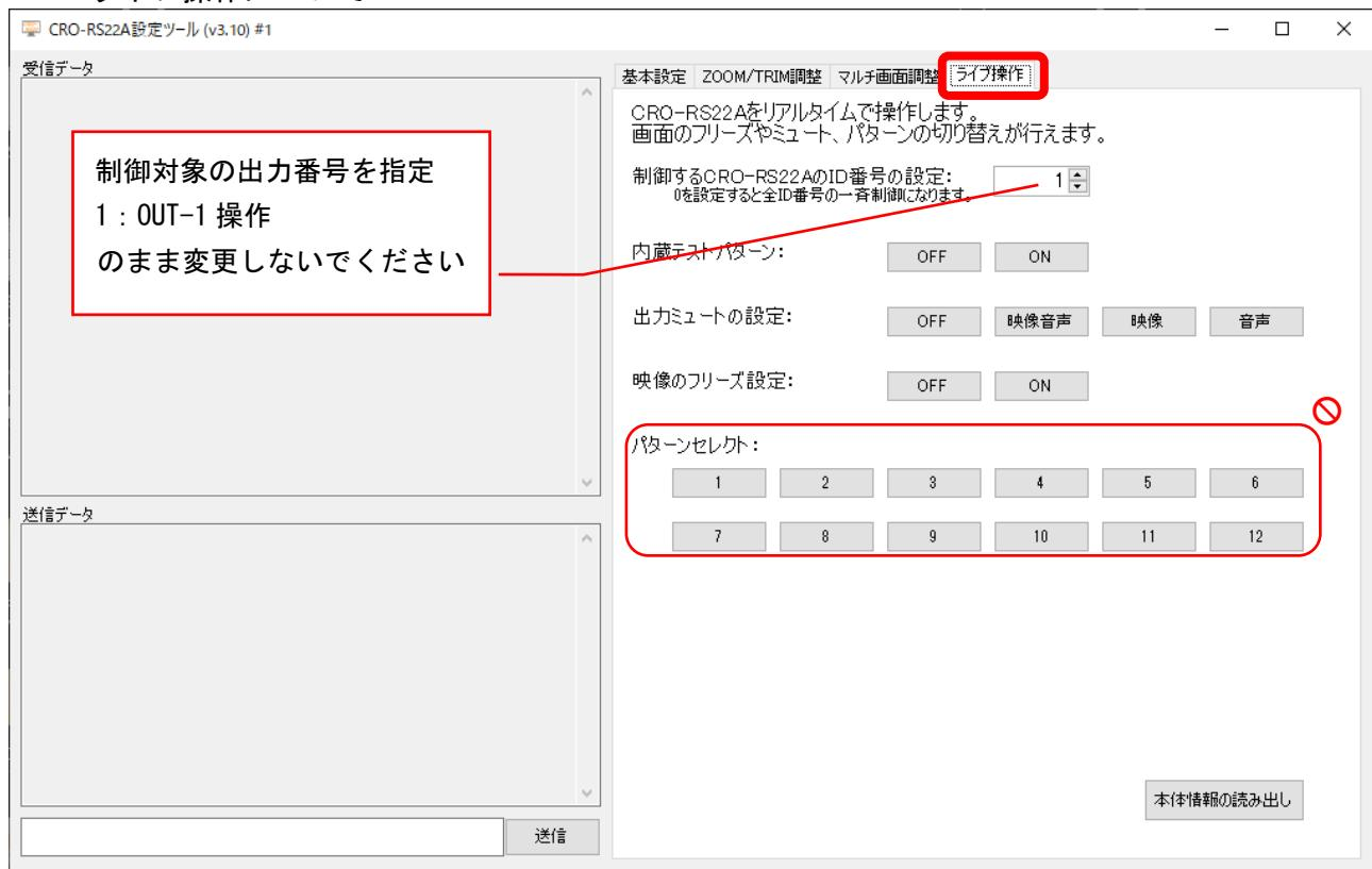
ライブ操作のタブでは、内蔵テストパターンの表示や、出力のミュート設定、映像のフリーズ設定など、バックアップメモリに保存されない、一時的な操作が実行できます。
