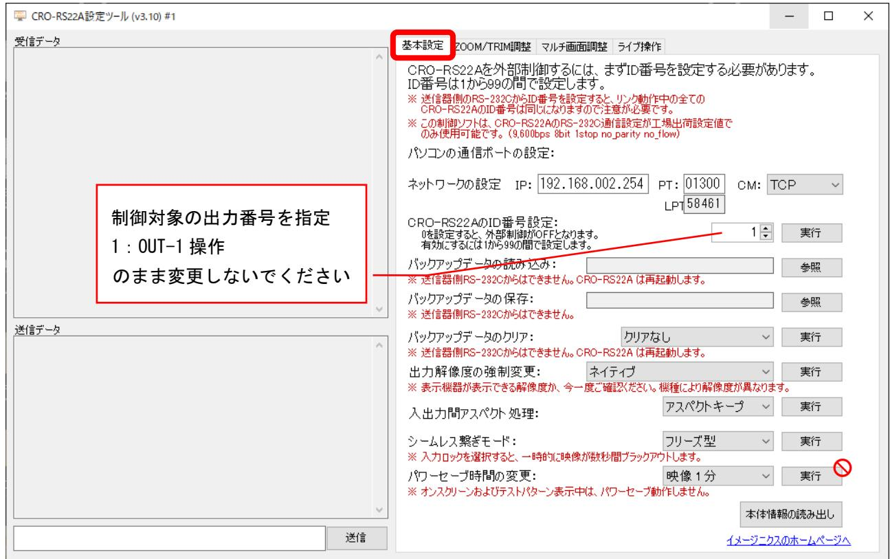
基本設定タブでは、バックアップデータ関連の操作、出力解像度の設定、アスペクト処理の設定が実行できます。
