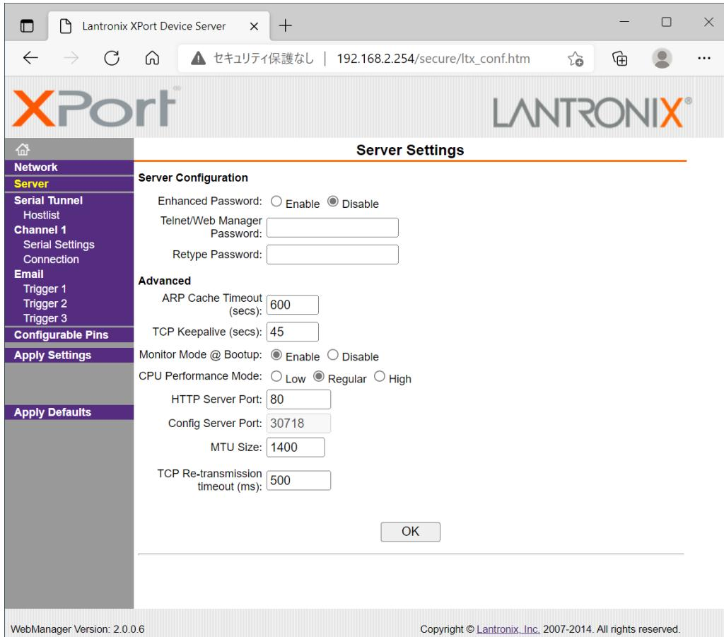
Server Configuration の Enhanced Password を Enable へ変更します。
