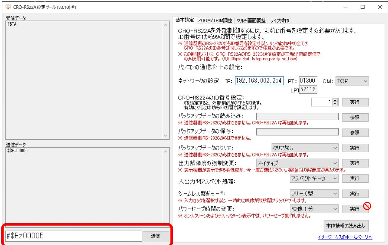
画面左下のテキストボックスに直接外部制御コマンド文字列を入力して、外部制御を実行することができます。CRO-R22A 設定アプリにて実装されていない US-41HRS 専用のコマンドはこちらから実行ください。テキストボックスの横の [送信] ボタンを押すことでコマンド文字列の末尾に [CR] コードを付与して US-41HRS にコマンド文字列を送信します。
