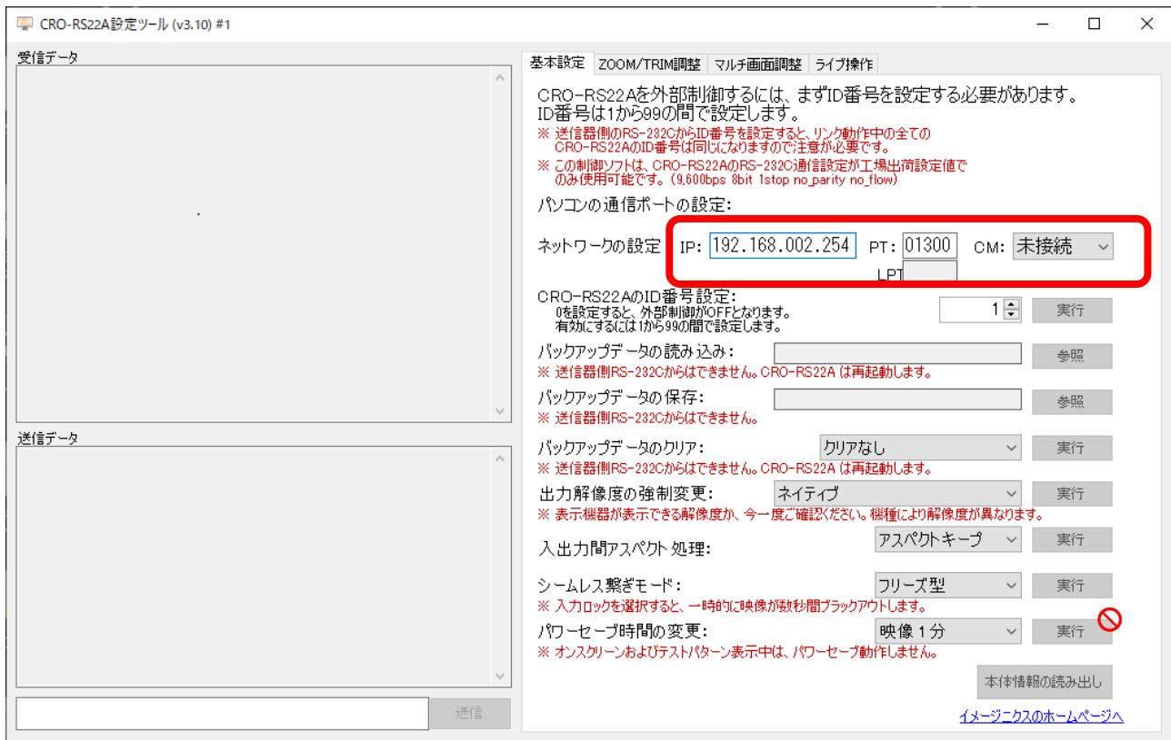
CRO-RS22A 設定アプリを起動したら、ネットワーク設定の「IP」と「PT」の項目に制御対象となる US-41HRS の IP アドレスとポート番号を入力して「CM」のプルダウンメニューから接続種別(TCP または UDP)を選択します。（工場出荷設定は IP:192.168.2.254/PT:1300/CM:TCP です。）
