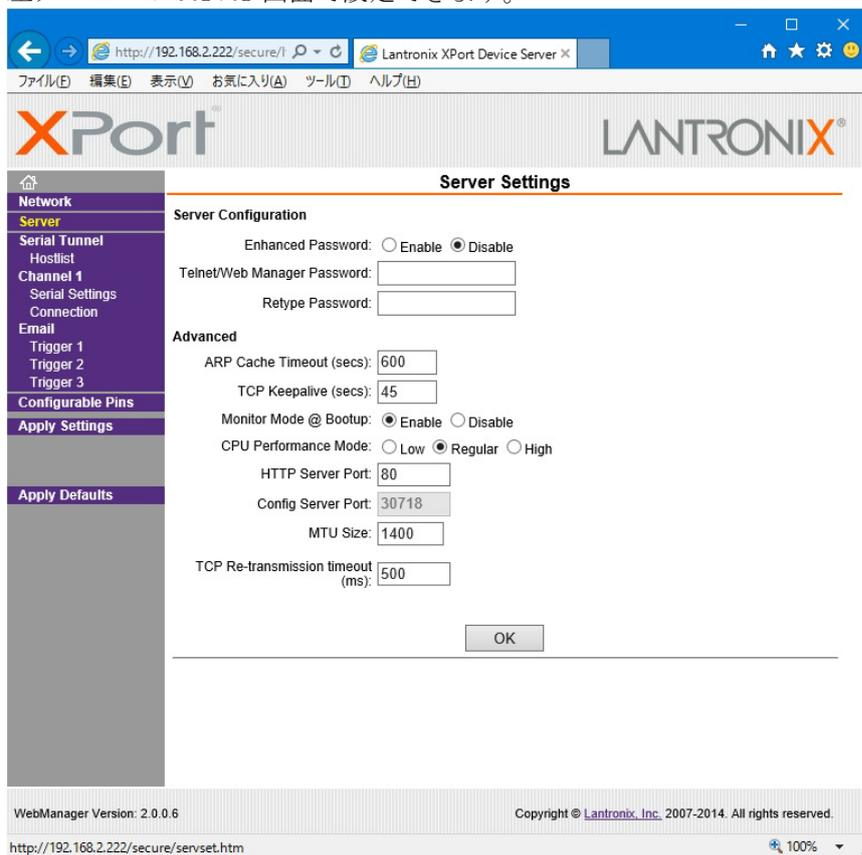
Server Configuration の Enhanced Password を Enable へ変更します。
