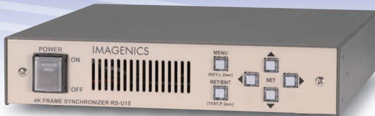
RS-U15は4K対応HDMI(DVI)信号フレームシンクロナイザです。高性能スキャンコンバート機能を内蔵し、予め設定している各種HDMI(DVI)フォーマットへ全自動変換して出力します。弊社製のHDMI(DVI)スイッチャでの切替えでは、フリーズ型などの疑似シームレス効果で映像を繋ぐことができます。アナログステレオ音声のエンベデット・デエンベデット機能、マルチ画面対応拡大縮小ズーム・90,180度回転機能・上下左右反転機能があり、LAN端子による外部制御にも対応しています。
