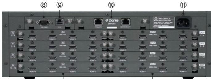
⑧ RS-232C端子 ⑨ ネットワーク端子 ⑩ 音声モジュール(Dante Audioモジュール実装時)
