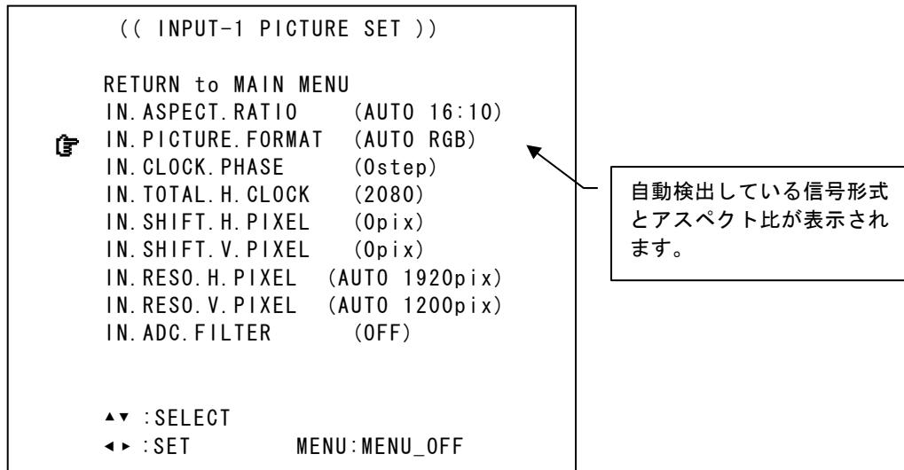
工場出荷設定時は共に AUTO です。入力信号を映像表示している状態で、必要に応じて切替えます。
