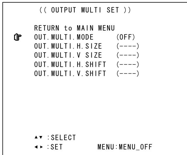
マルチ画面動作を選択するには、OUT. MULTI. MODE を OFF 以外の設定に変更します。その後、必要な画面サイズ調整を、下表を参照に行います。
