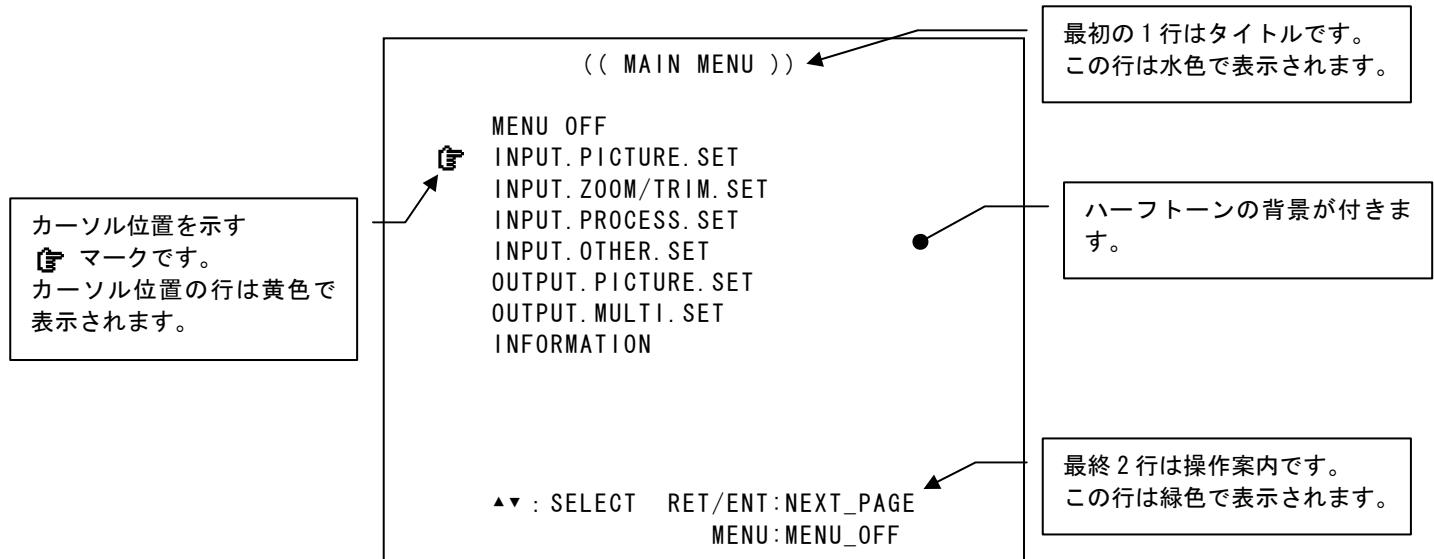
メインメニュー表示で調整したい項目にカーソル を SET 上下押しボタンで合わせ、RET/ENT 押しボタンを押します。先の例で RET/ENT 押しボタンを押すと、次の様な調整メニューを表示します。
