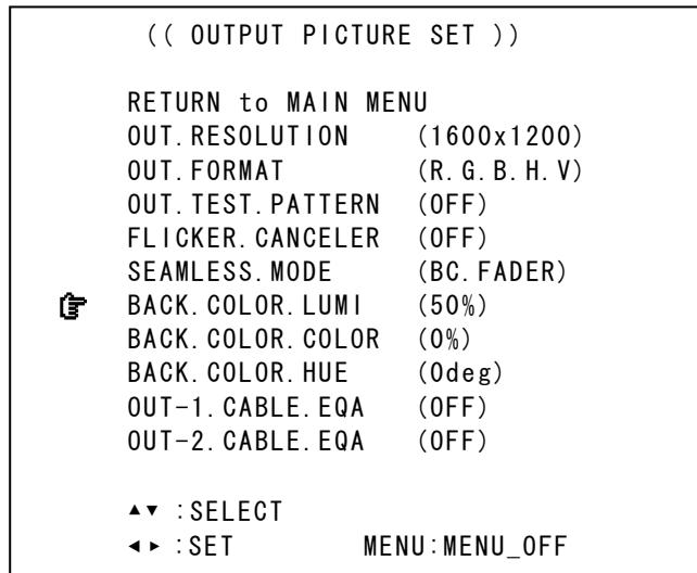
バックカラー調整中、本機の映像出力は強制的に全画面バックカラーが表示されます。
