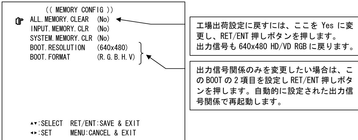
**☞** マークを設定したい項目に、フロントのSET上下押しボタンで合せ、SET左右押しボタンで項目を変更します。最後にフロントのRET/ENT押しボタンを押すと、変更された内容を保存し、RS-1500が自動的に再起動します。
