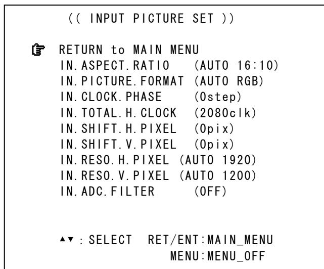
カーソルを調整したい項目にSET上下押しボタンで合わせ、SET左右押しボタンで設定値を変更します。設定変更はすぐに映像へ適応され、後にバックアップメモリーにも保存されます。
