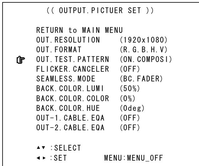
この複合テストパターンを用いて、表示機器と本機をアナログ信号接続した際の、表示機器側調整を容易に行えます。デジタル信号接続の場合は、通常調整の必要はありませんが、表示機器によっては水平垂直位置の微調整が必要な場合もあります。
