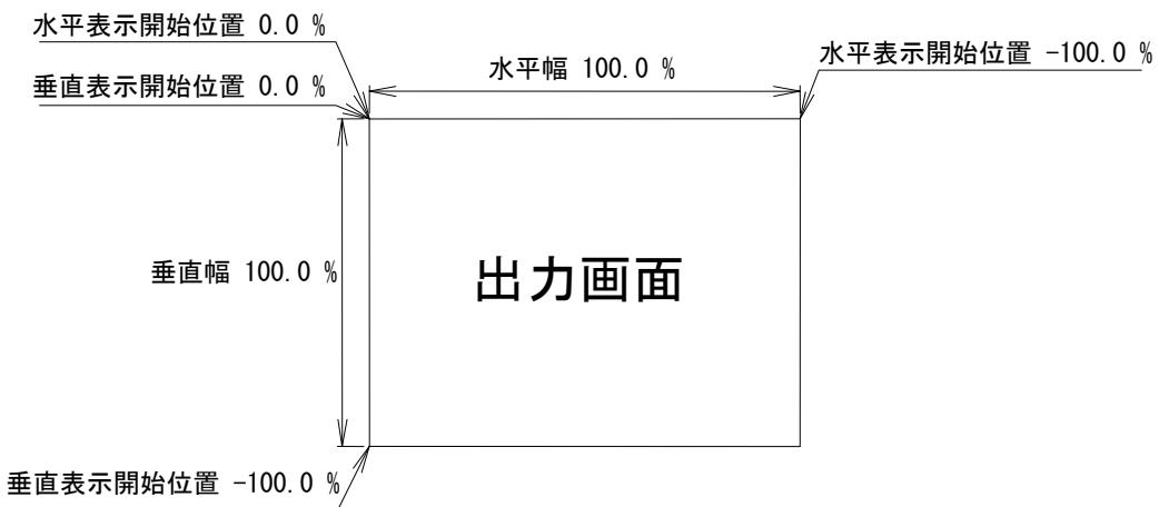
上図は、1つの出力画面（表示機器の画面）を表しています。マルチ画面動作設定が OFF のときの、出力画面イメージです。このとき、レターボックス・サイドプランク表示時のバックカラー表示部分も含みます。出力画面が4:3でも16:9でも、各%数値は同じです。
