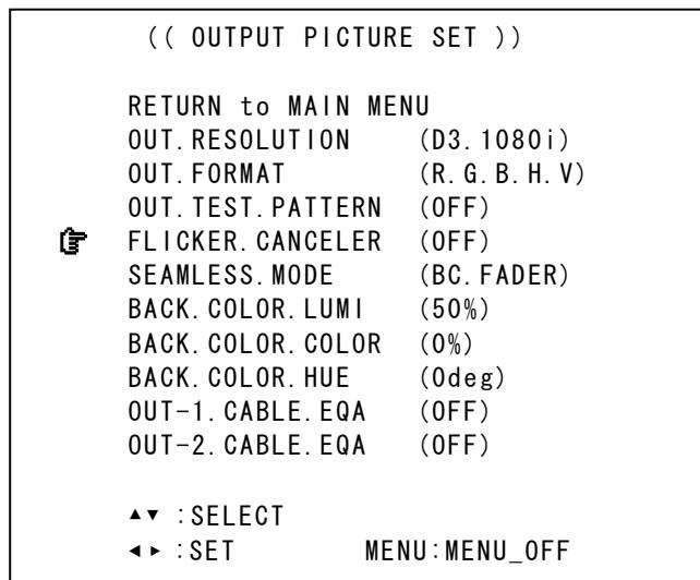
工場出荷設定は OFF です。システムでの必要に応じて、WEAK, MIDDLE, STRONG から選択できます。フリッcker抑圧能力を高くするに従って、垂直解像度も多少劣化します。
