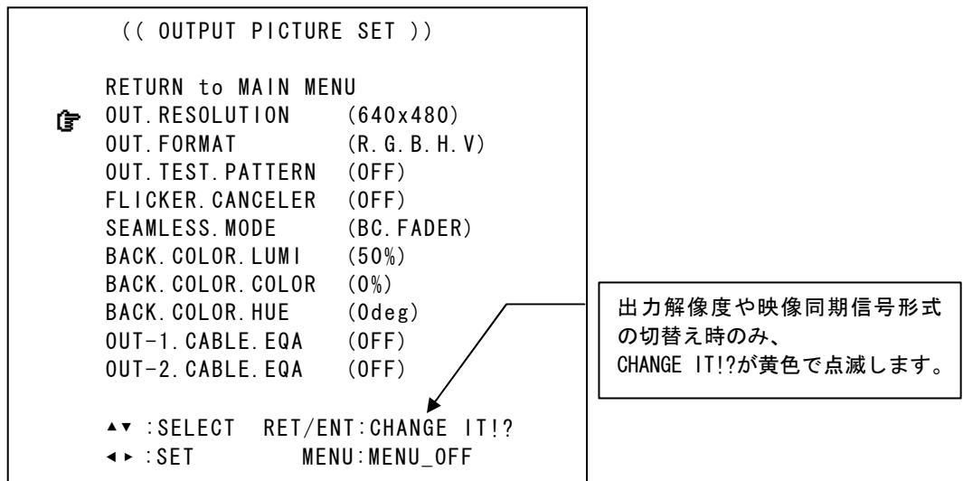
OUT. RESOLUTION にカーソルを合わせ、SET 左右で目的の解像度を表示し、RET/ENT 押しボタンを押します。
