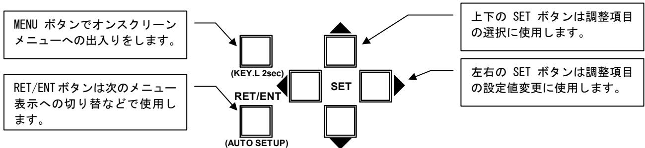
MENU 押しボタンの長押しでキーロック状態への設定・解除ができます。
