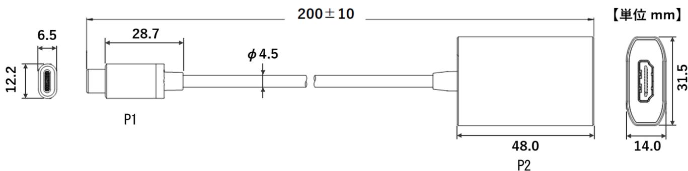
USB-Type-C 信号⇒HDMI 信号変換モジュール
